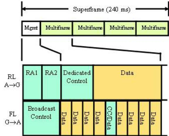
Fig. 2. L-DACS1 physical layer framing
